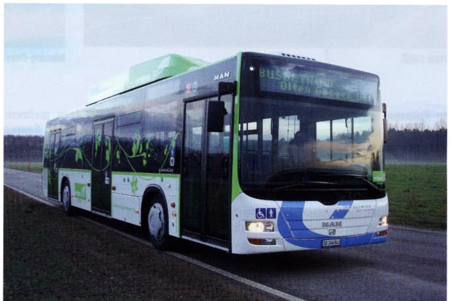
MAN Lion's City A21 CNG mit 12,8 Liter EEV-Abgasstandard Gasmotor (310 PS), der GÖGG Busbetriebe Olten - Gösigen - Gäu.
